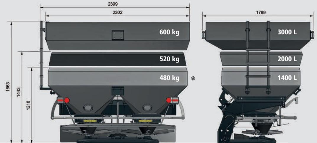
\* Peso en kg. del modelo Jolly 24 con apertura hidráulica sin báscula electrónica.
