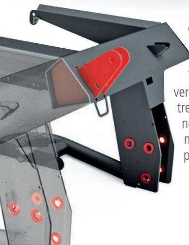
**Chasis:** Resistencia estructural con **carga max. útil de hasta 3600 kg.** Tirajes de II y III categoría y versatilidad de enganche con tres posiciones diferentes: normal, Avanzado de 100 mms, o elevado de 150 mms para **fertilizaciones tardías.**
