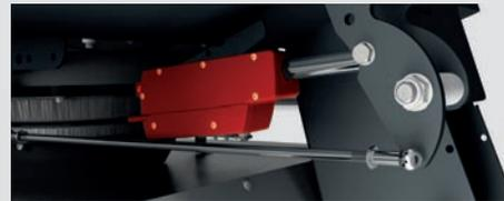
Dos **sensores** magnéticos detectan la apertura exacta de cada **compuerta**, controlando los servomotores y eliminando cualquier posible error de posición.
