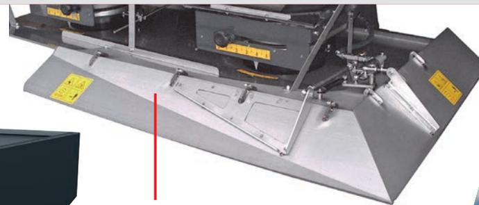
**Linde:** con este dispositivo hidráulico para fertilizar el encabezado de las parcelas (con pasajes a tan solo 2 mtrs. del límite del borde) se asegura que el fertilizante no exceda la superficie de trabajo.
