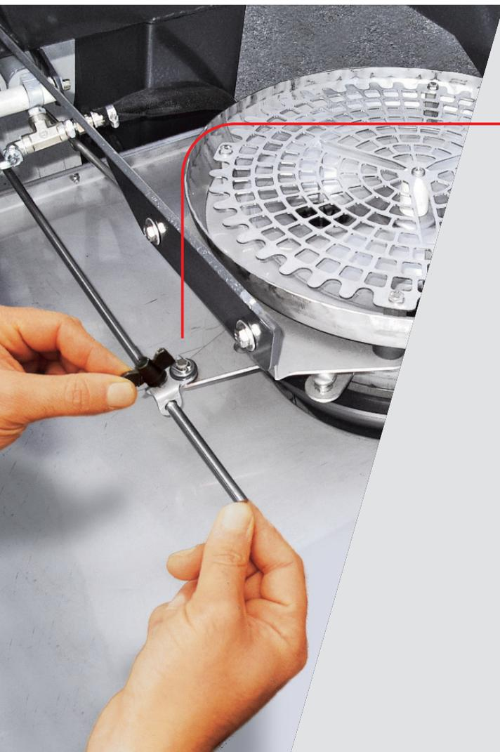
El sistema de **posicionamiento automático** optimiza la entrada del abono en el disco esparcidor de acuerdo con el aumento de la cantidad dispensada.
