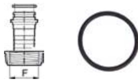
Juntas Tóricas para Espigas O-Rings for hose fittings OR pour raccords de tuyaux
